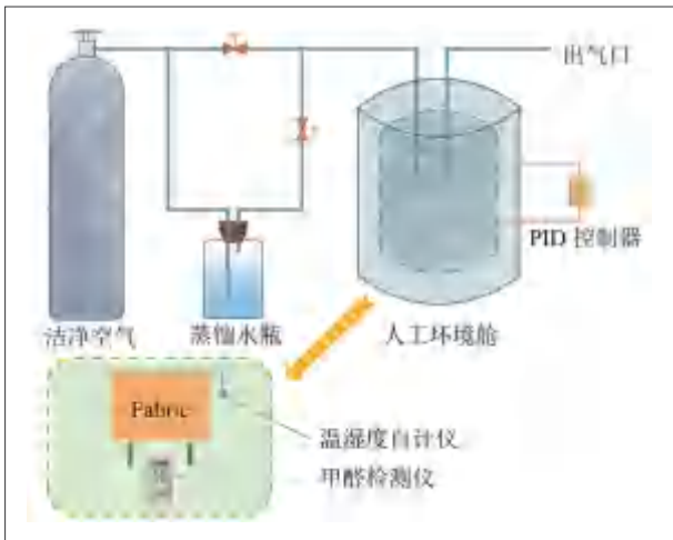
图1 环境舱实验系统示意图
